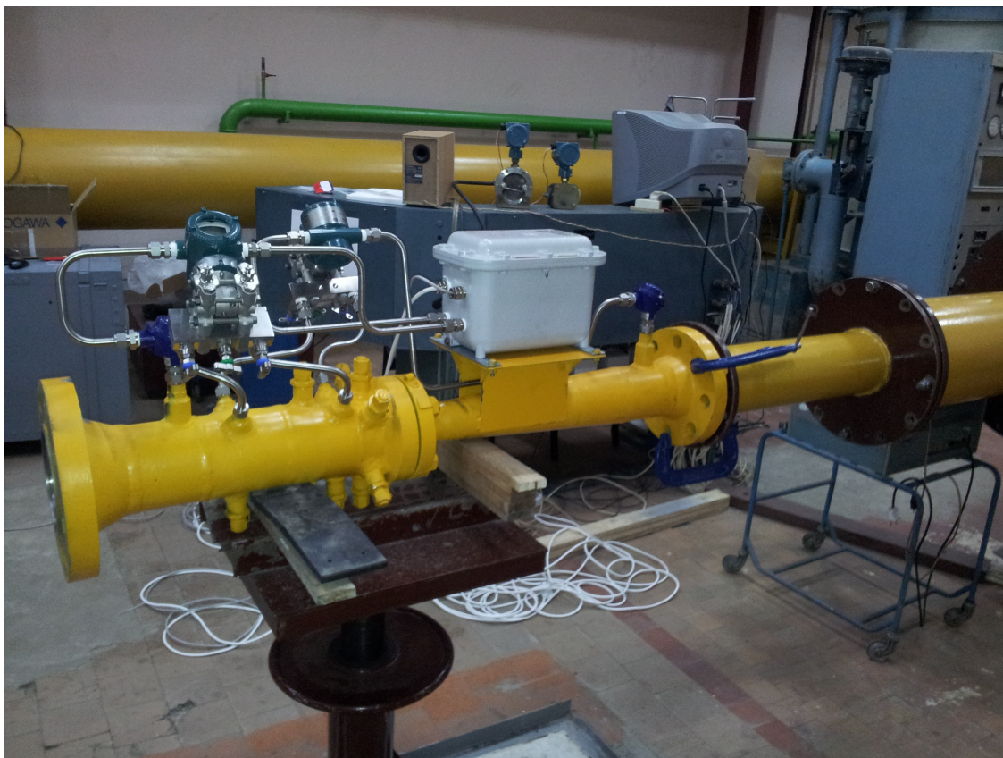
Рис. 7. Расходомер «ВИТ – Поток» на испытательном стенде ФГУП ВНИИР, г. Казань. Испытания проводились без использования дополнительных прямых участков трубы.
