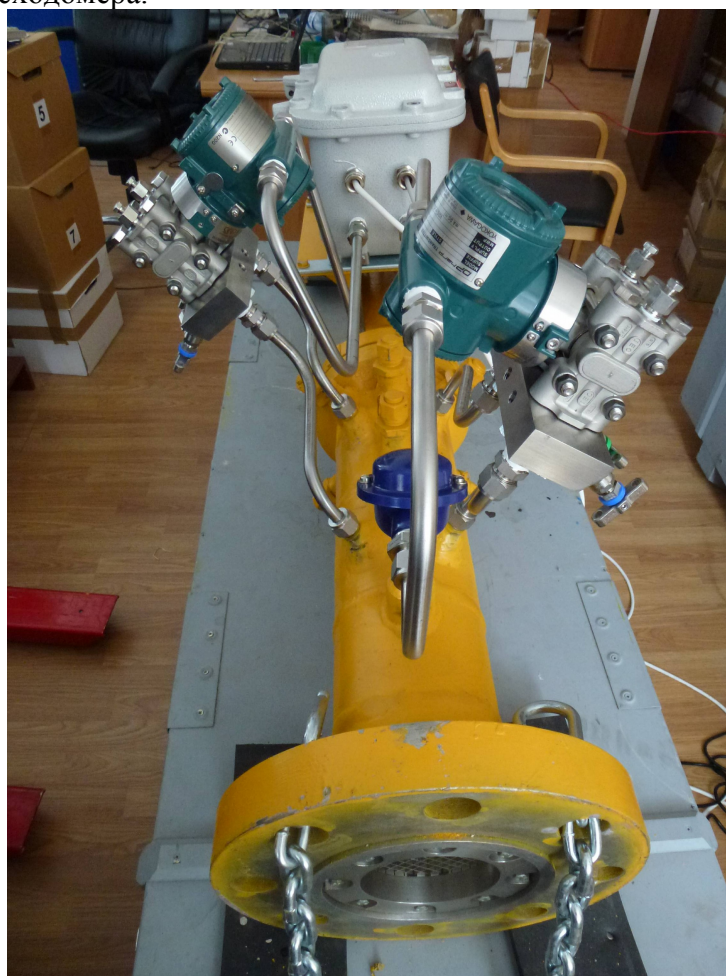
Рис. 4 Монтаж трубопроводов высокого давления и информационных линий.
