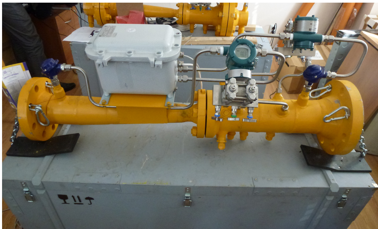
Рис. 2. ПРФ «ВИТ – поток 100/16,0 Н/Г» в собранном виде перед упаковкой в транспортную тару. Видны датчики давления Yokogawa и термометры Wika. На расходомере установлен вычислитель «ВИТ УВР - 002» производства НПП «ВИТ».
